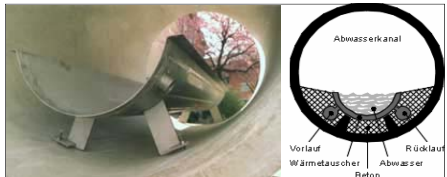
Abb. 18: Rinnenwärmetauscher für Kanäle mit Kreisprofil
